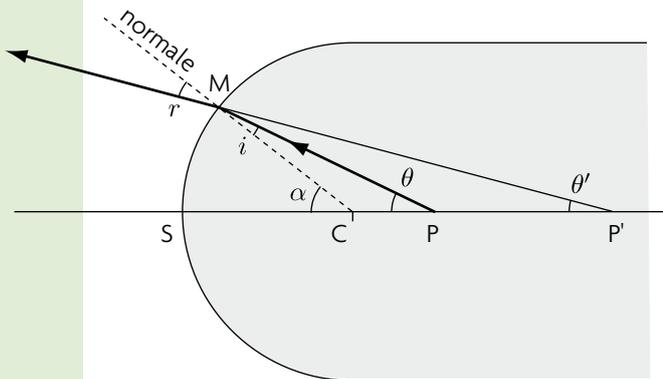
Un dioptre sphérique, concave, de rayon  $R$ , de centre  $C$ , sépare un milieu extérieur d'indice 1 d'un milieu intérieur d'indice  $n$ . On appelle  $S$  son sommet (intersection du dioptre avec l'axe optique). On place un objet  $P$  à l'intérieur du dioptre, comme indiqué sur la figure. Pour un rayon lumineux issu de  $P$  et traversant le dioptre, on note  $P'$  l'intersection du rayon réfracté avec l'axe optique. On ne se place pas dans les conditions de Gauss.
